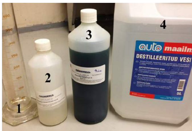
▲ Joonis 6 | Nikli töölahuse vajalikud komponendid: 1 – mensuur, 2 – nikli komponent. Osa B, 3 –elektivaba. Osa A, 4 – destilleeritud vesi
