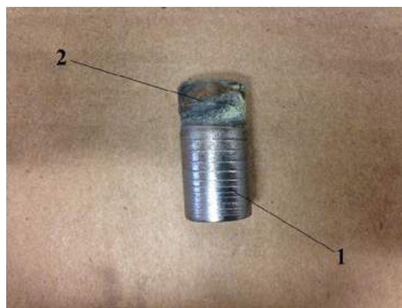
▲ Joonis 4B | B – nikliga pinnatud malm (1 – pinnatud osa, 2 – malmi pindamata osa)
