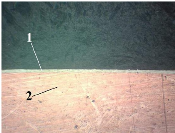
▲ Joonis 13 | Boornitriidiga pinnatud teras (1 – teras, 2 – boornitriidpinne)
