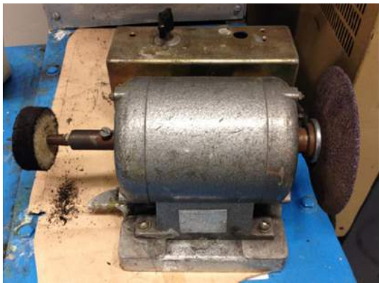
▲ Joonis 1 | Käi katsekehade poleerimiseks, töötlemiseks (1 – alumiinium, 2 – malm, 3 – vask, 4 – teras)
