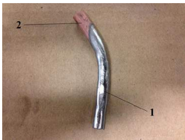
▲ Joonis 4A | Nikliga pinnatud vask. A (1 – nikli pinne vasel, 2 – vase pindamata osa)
