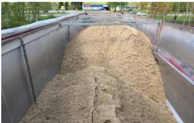
▲ Foto 1 | 55 t tegeliku massiga veok Türi-Alliku silla katsetamisel 2019. a, mille poolhaagis oli pooltühi ja võimaldanuks ka oluliselt suuremat koormust [9]
