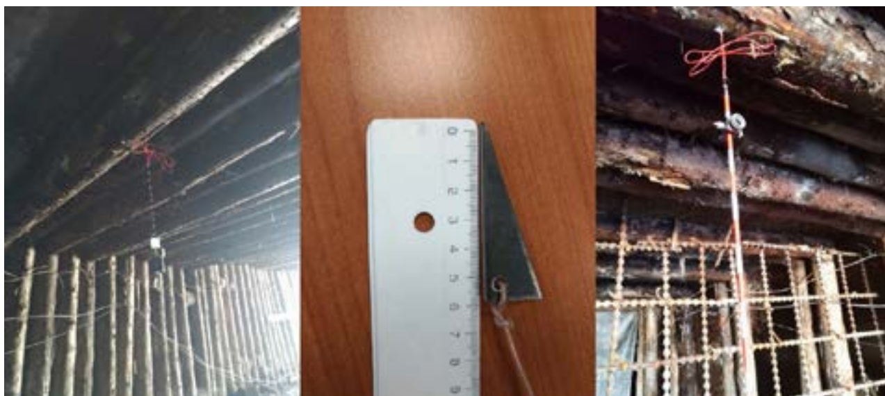
▲ Foto 1. | Vasakul joonisel on tagumise põhipunkti külge riputatav latern; keskmisel joonisel põhipunkti tähistamiseks-kindlustamiseks kasutatav metallist kolmnurkne märk, mille auk näitab põhipunkti asukohta; paremal joonisel miniprisma kauguse mõõtmiseks).
