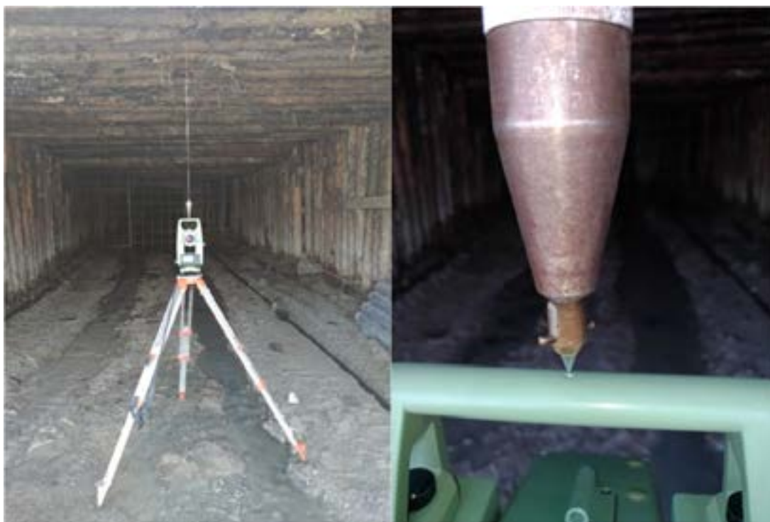
▲ Foto 2. | Põhipunktil tsentreeritud elektrontahhümeeter: vasakul on üldvaade; paremal on näha nõorloodi ja kärni ühitamine.
