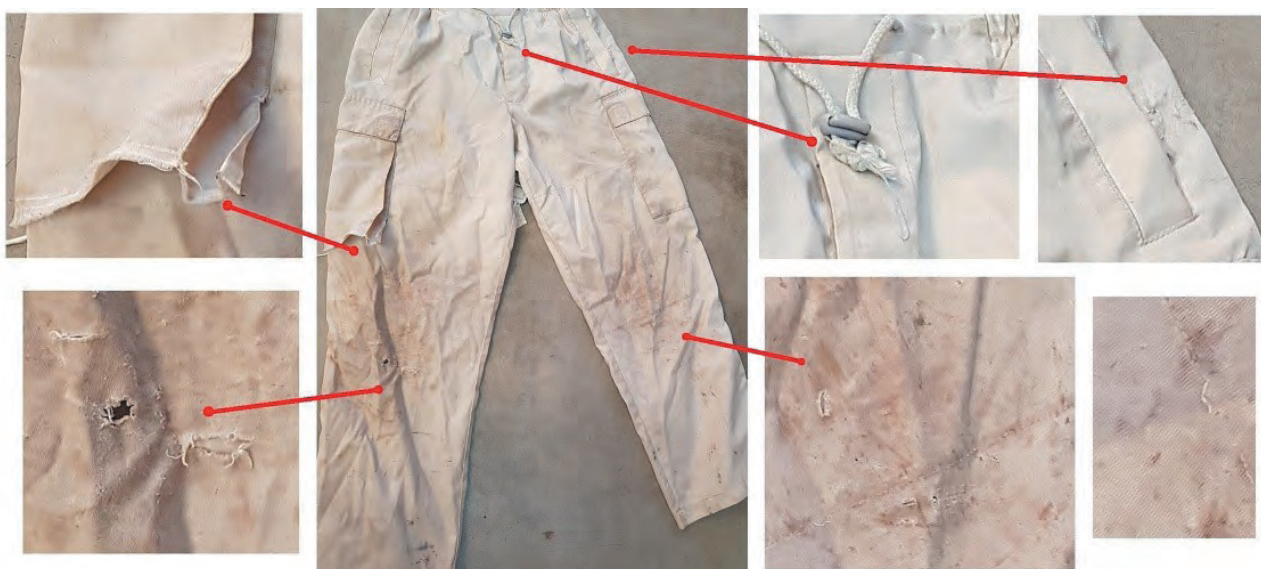
Joonis 3. Määrduvad ja kulunud vormipüksid
