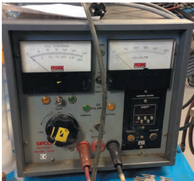
Sele 3. Toiteallikas Sifco process 3030 [12]
