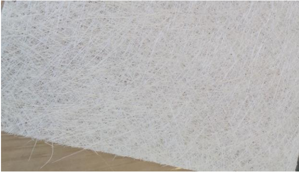
Foto 4. Põrandate 2 ja 4 tugevdamiseks kasutatud klaasfiibri näidis
