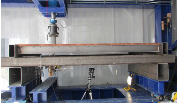
Foto 7 ja joonis 4. Konstruktsiooni paiknemine jõuraamil
