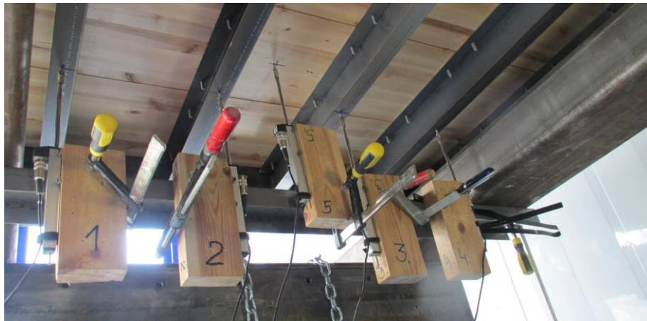
Foto 8. Potentsiomeetriliste andurite paiknemine põrandakonstruktsiooni all
