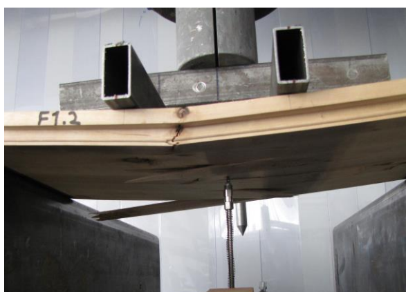
Foto 10. Põrandalaua F1.2 purunemispilt
