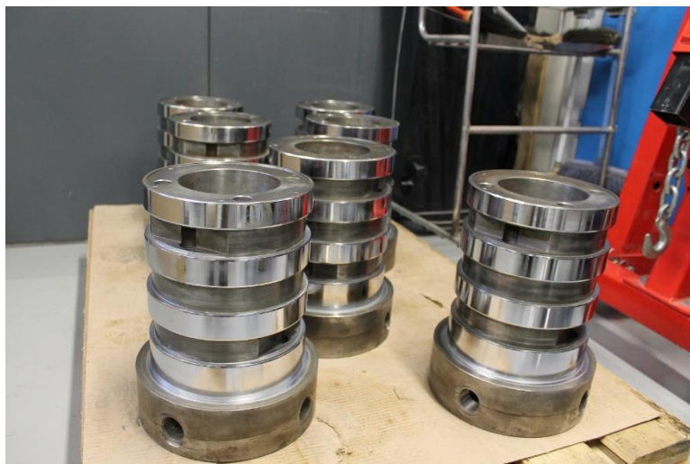
Joonis 7. Kromeeritud detailide astmete lokaalsete defektide parandused
