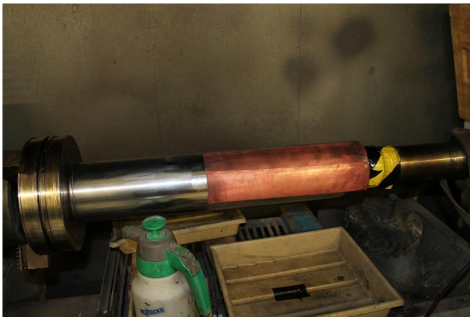
Joonis 5. Pinna konaruste täitmiseks valmistatud vase baasil pinne
