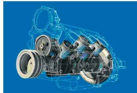
Joonis 1. Auto vāntmehhanismi liikuvate osade virtuaalne mudel, auto mootori plokk ja karter on kujutatud läbipaistva traatumudelina, näidatud on ainult mootori liikuvaid osi. Liikuvatele osadele võib anda kinemaatilise liikumise simulatsiooni, et kontrollida üksiteist sõltuvate osade liikumise korratust. Sellise pildi järgi ei ole võimalik ilma joonisteta valmistada ühtegi detaili ega ka panna kokku sellist mootorit. Selleks, et seda mootorit toota, on tarvis teha vārn jooniseid, juhiseid, skeeme ja muud liiki tehnilist dokumentatsiooni.
