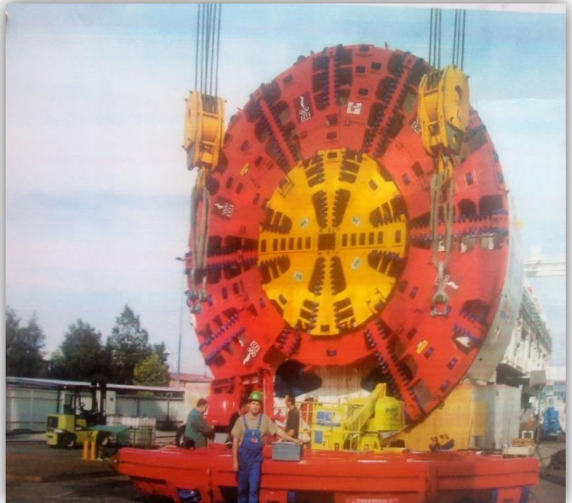
Pildil ühe Gläser GmbH pikaajaliseima partneri, Herrenknecht AG, valmistatud tunnelipuurimismasin. Gläser varustab Herrenknechti hüdraulika juhtplokkidega
