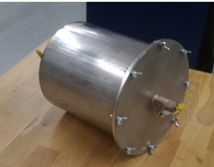
Joonis 3. Pidekshalatsiooni mõõtmiseks valminud kogumiskamber.
