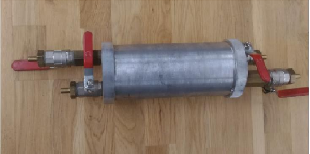
Joonis 2. Massekshalatsiooni kiiruse mõõtmisteks kasutatud kogumiskamber.
