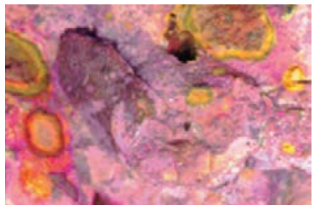
▲ Foto 4 | ASRi protsessi tuvastamine kivistunud betoonis [17]
